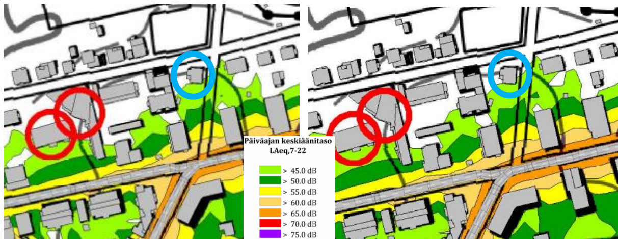
Kuva 19. Vasemmalla nykytilanteen v. 2020 päiväajan keskiäänitasot ja oikealla ennustetilanteen v. 2040 päiväajan keskiäänitasot (WSP 2021). Punaisilla ympyröillä on merkitty melulle herkät kohteet eli päiväkodit, koulut ja hoitolaitokset. Suunnittelualue on merkitty sinisellä ympyrällä.
